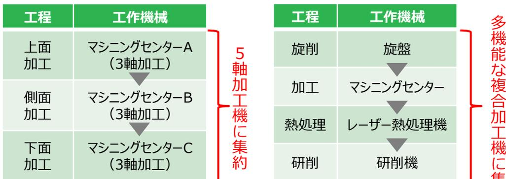
※同じ工程内で集約する5軸加工機よりも、複数工程を集約する複合加工機のほうが難易度が高い。
